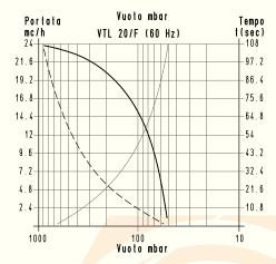
Per i tempi di svuotamento di un volume  $V_1$  applicare la formula  $t_1 = \frac{t \times V_1}{100}$
