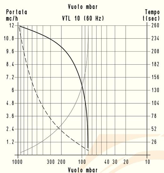
Per i tempi di svuotamento di un volume  $V_v$  applicare la formula  $t_c = \frac{t \times V_v}{100}$
