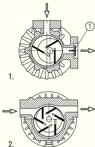
Il rotore ruota eccentricamente all'interno di uno statore ed è dotato di scanalature nelle quali scorrono libere le palette che, per effetto della forza centrifuga, vengono spinte contro la parete interna dello statore, formando tante camere quante sono le palette. Durante la rotazione, il volume di queste camere varia in funzione della posizione in cui esse si vengono a trovare rispetto all'asse eccentrico.
