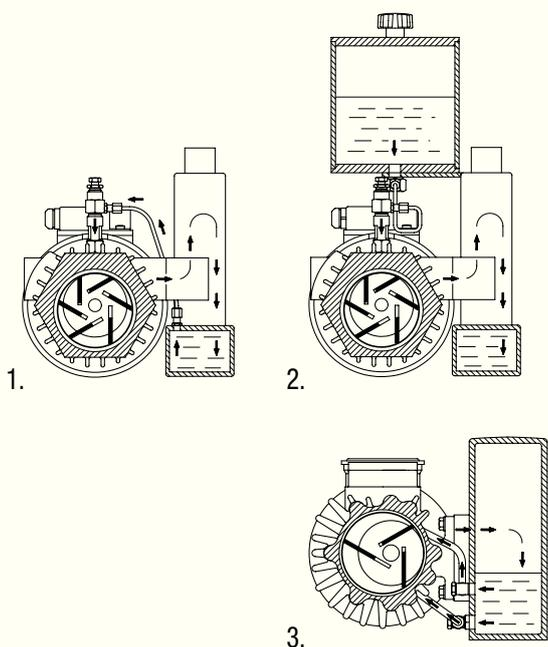
I principali sistemi di lubrificazione da noi adottati sono a depressione con riciclo d'olio o con olio a perdere per le pompe per vuoto della serie VTL e a bagno d'olio per le pompe della serie MV.
