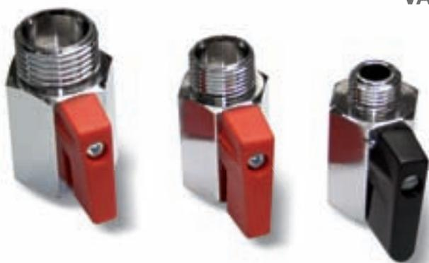
Queste piccole valvole, ad azionamento manuale, sono adatte per intercettare il vuoto ai portaventose ed a tutte quelle piccole utenze dove non è possibile installare le elettrovalvole. Sono costituite da un corpo esagonale in ottone nichelato, da un otturatore sferico d'ottone cromato e da una guarnizione in materiale plastico per garantire la tenuta. Una levetta, impernata sull'otturatore sferico, ruotata manualmente di 90°, consente di aprire o di chiudere la valvola con un minimo sforzo.
