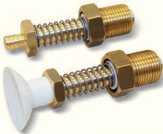
Oltre alle ridotte dimensioni del portaventose, la loro particolare conformazione ne consente l'assemblaggio diretto al collettore del vuoto, con notevole risparmio di tempo e l'eliminazione di tubi e raccordi.
